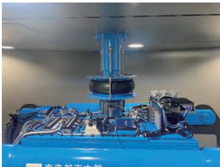
遠心装置の上部には計測ロガー、電源機器、制御機器などを設置可能です。
